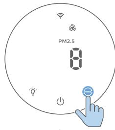
ターボ・モード（🌀）：空気清浄機は最大回転速度で動作します。
