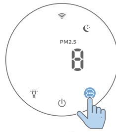
スリープ・モード（🌙）：空気清浄機は低速で静かに動作します。3秒後、画面が消灯します。
