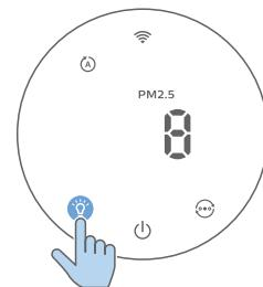
光センサを使用すると、周囲光の明るさに合わせて、コントロール・パネルの電源を自動的にオン、オフ、または暗くすることができます。周囲光が暗いと、コントロール・パネルはオフになるか暗くなります。任意のボタンをタッチすると、すべてのライトを点灯させることができます。その後、これ以上の操作を行わない場合、すべてのライトが消灯するか、または周囲光に合わせて再び暗くなります。
