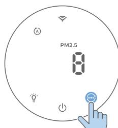
自動モード (⌚) : 空気清浄機は周囲の空気品質に応じてファン回転速度を自動的に調整します。
