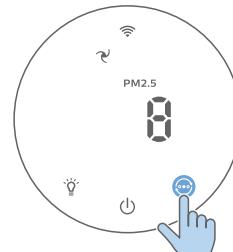
手動速度 (🌀 および 🌟) : 手動モードでは、空気清浄機は速度 1 または速度 2 で動作します。
