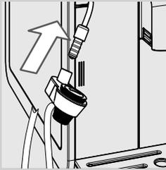
**26** Odstranite mali beli filter in ponovno vstavite vodni filter "INTENZA+" (če je prisoten) v rezervoar za vodo in vstavite avtomatski penilec mleka.
