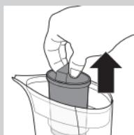
**2** Χρησιμοποιήστε τη λαβή της χρησιμοποιημένης κασέτας υλικού αφαλάτωσης για να την αναστηκώσετε και να τη βγάλετε από το δοχείο φιλτραρίσματος.
