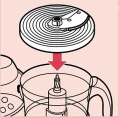
**4** Coloquen el disco rebanador ajustable en el soporte para herramientas.
