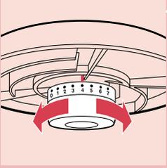
**3** Giren el botón de ajuste para ajustar el espesor que deséen.
