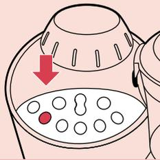
**6** Presionen el botón Proceso de Batido (Blending Process) del panel de control. La batidora empezará a funcionar. La velocidad se incrementará hasta la velocidad máxima. El aparato seguirá funcionando a esa velocidad hasta que el botón Paro (Stop) sea apretado. Durante el Proceso de Batido (Blending Process) la velocidad puede disminuirse hasta 3 veces presionando el botón "-".
