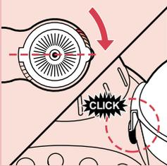
**2** Giren el cedazo en la dirección de la flecha hasta que la espiga del cierre de seguridad se fije en su lugar en la unidad motora.
