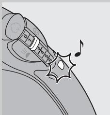
**D Ak sa vypne ohrevné teleso, začne blikat kontrolné svetlo, ktoré označuje automatické vypnutie a zaznie zvukový signál.**
