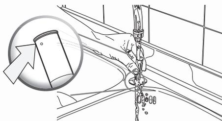
Avec un chiffon humide, laver la partie fixe qui reste installé sur la buse vapeur/eau chaude.
