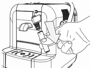
Lave a parte removida com água tépida para eliminar todas as marcas de leite.
