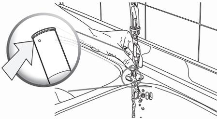
Rengör den resterande delen som sitter fast på ång-/varmvattenröret med en fuktig trasa.
