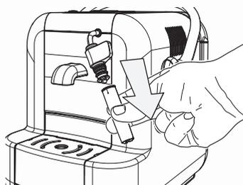
Vask den afmonterede del med lunkent vand for at fjerne alle spor af mælk.
