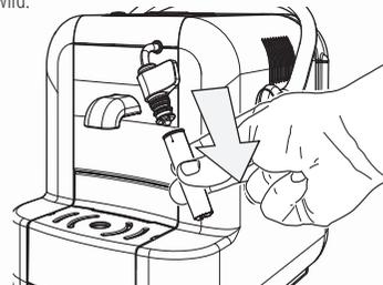
Das abgenommene Teil mit lauwarmem Wasser reinigen, um alle Milchrückstände zu entfernen.
