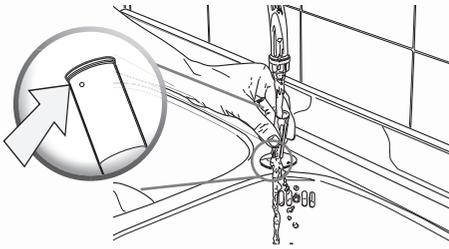
Utilizando un paño húmedo, lavar la parte fija que queda instalada en el tubo de vapor/agua caliente.
