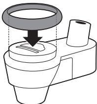
**11** Fäst den automatiska mjölkskummaren på varmvatten-/ångpipen igen.
