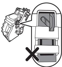
Obs! Haken är inte i rätt läge om den fortfarande är i det längsta läget.
