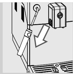
**2** Снимите классический вспениватель молока с трубы пара/горячей воды.
