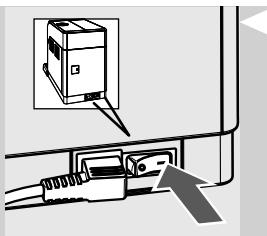
**12** Установите главный выключатель на «I» для включения машины.
