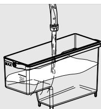
**17** Когда бак для воды опускает, извлеките его, ополосните и наполните свежей водой до указателя уровня MAX. Вставьте его обратно в машину.
