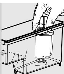
**4** Вставьте фильтр для воды «INTENZA +» в пустой бак для воды. Сдвиньте его как можно ниже.
