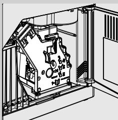
**12** Ополоснув блок приготовления кофе, вставьте его обратно в гнездо так, чтобы он защелкнулся в нужном положении (см. главу «Еженедельная чистка блока приготовления кофе»). Вставьте поддон для сбора капель и контейнер для сбора отходов. Закройте дверцу для обслуживания.
