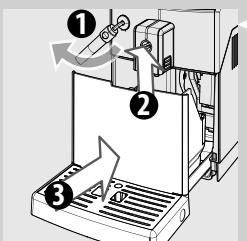
**4** Вставьте контейнер для сбора отходов в поддон для сбора капель и установите его в машину.
