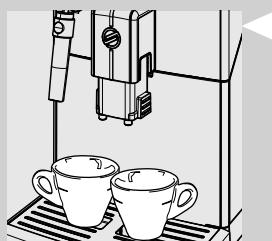
Под устройством подачи могут быть размещены две чашки для одновременной подачи двух кофе или двух эспрессо.
