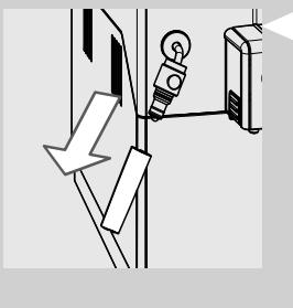
**1** Снимите внешнюю часть классического вспенивателя молока. Промойте ее теплой водой.
