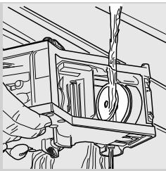
**11** Тщательно промойте блок приготовления кофе свежей водой.
