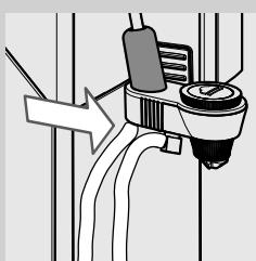
**12** După utilizare, furtunul de aspirare poate fi reașezat conform ilustrației din figură.
