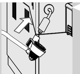
**27** Introduceți dispozitivul automat de spumare a laptelui în protecția din cauciuc.
