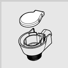
**20** Scoateți capacul din cauciuc conform ilustrației din figură.
