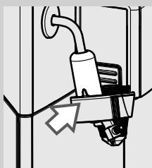
**18** Verificați dacă este poziționat corect. Dacă nu reușiți să îl introduceți, trebuie să roțiți capacul cromat. Dispozitivul automat de spumare a laptelui este montat corect atunci când dintele intră în canelură.
