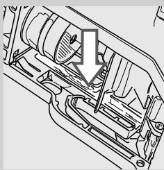
**1** Aplicați lubrifiantul în mod uniform și pe ambele ghidaje laterale.
