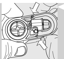
**23** Montați dispozitivul automat de spumare a laptelui în racord, asigurându-vă că îl fixați bine în locașurile evidențiate.
