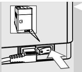
**12** Deplasați întrerupătorul general în poziția „I”. Tasta „
