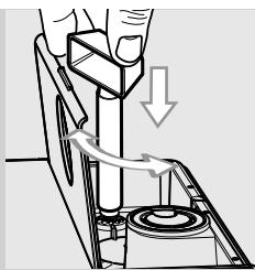
**2** În timp ce aparatul macină, apăsați și roțiți manivela de reglare a grădului de măcinare amplasată în interiorul compartimentului pentru cafea boabe până când face câte un clic. Folosiți cheia specială de reglare a râșniței de cafea din dotare. Diferența de gust va fi perceptibilă după prepararea a 2-3 cafele.
