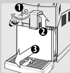
**16** Pentru curățarea cuvei de colectare a picăturilor, așezați în interiorul acesteia o pastilă degresantă și umpleți-o cu apă caldă până la 2/3 din capacitatea sa. Lăsați soluția de curățare să acționeze timp de aproximativ 30 de minute, apoi clătiți cu apă din abundență.
