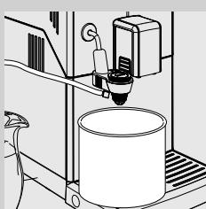
**4** Așezați un recipient încăpător (1,5 l) sub dispozitivul automat de spumare a laptelui.
