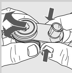
**19** Pentru a demonta dispozitivul automat de spumare a laptelui, apăsați pe părțile laterale ale acestuia și extrageți-l efectuând mișcări laterale ușoare, conform ilustrației din figură.
