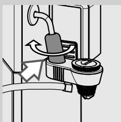
**28** Verificați dacă este poziționat corect. Dacă nu reușiți să îl introduceți, trebuie să roțiți capacul cromat. Dispozitivul automat de spumare a laptelui este montat corect atunci când dintele intră în canelură.
