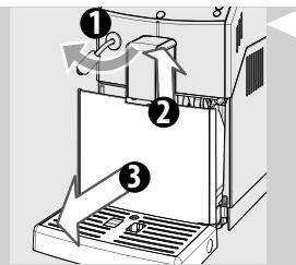
**11** Goliți cuva de colectare a picăturilor și introduceți-o la loc pe poziție.
