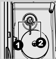
**3** Marcajele amplasate în interiorul compartimentului pentru cafea boabe indică gradul de măcinare setat. Se pot configura 5 grade diferite de măcinare, de la poziția 1 (●) pentru o măcinare grosieră și un gust mai puțin intens la poziția 2 (•) pentru o măcinare fină și un gust mai intens. În cazul în care cafeaua este apoasă sau ieșe lent, modificați setările râșniței de cafea.
