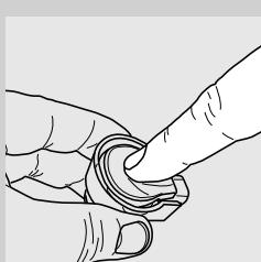
**22** Montați capacul apăsând pe partea centrală a acestuia; asigurați-vă că este instalat bine.
