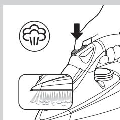
Izpust pare iz posebne likalne plošče Steam Tip pomaga zgladiti trdovratne gube. Izpust pare izboljša porazdelitev pare, da doseže vse pore oblačila. Ta funkcija deluje pri nastavljivah temperature med ●●● in MAX.
