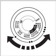
**3** Nõutud triikimistemperatuuri seadmiseks pöörake temperatuuri ketasregulaator sobivasse asendisse (vt alolevat tabelit „Temperatuuri- ja auruseaded”).
