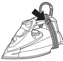
**1** Înfăşuraţi cablul de alimentare în jurul suportului de depozitare a cablului şi fixaţi-l cu clema.
