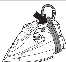
**4** Намотайте шнур питания на приспособление для хранения шнура и закрепите его зажимом для шнура.
