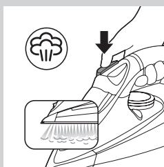
Parní ráz z žehlicí plochy se speciální napařovací špičkou Stem Tip pomáhá odstranit nepoddajné záhyby. Parní ráz umožňuje rozložení páry do všech částí oblečení.
