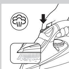
Silne uderzenie pary ze stopy żelazka ze specjalną końcówką Steam Tip pomaga usunąć najbardziej oporne zagniecenia. Zwiększa ono ilość pary trafiającej do każdej części prasowanej tkaniny. Funkcji silnego uderzenia pary można używać wyłącznie przy ustawieniach temperatury od ●●● do „MAX”.
