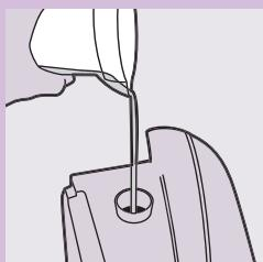
**6** Umpleți generatorul de abur cu apă proaspătă cu ajutorul paharului și pâlniei, și agitați din nou.
