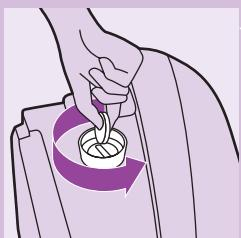
**4** Okrenite posudu za paru na stranu i skinite zatvarač i čep za Calc-Clean ispiranje pomoću isporučenog specijalnog ključa ili novčića.
