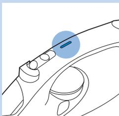
Funkce bezpečnostního automatického vypnutí žehličku automaticky vypne, pokud je 30 minut na žehlicí ploše a nepoužívá se a nebo 8 minut stojí na zadní straně. Rozsvítí se kontrolka automatického vypnutí.
