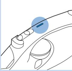
Funcția de oprire automată de siguranță oprește automat fierul de călcat dacă nu este utilizat timp de 30 de secunde, când este așezat pe talpă, sau timp de 8 minute când este așezat în poziție verticală. Se va aprinde ledul de oprire automată.
