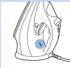
**3** Állítsa a vasalót függőleges helyzetbe, és csatlakoztassa a fali aljzatba. A hőmérsékletjelző fény bekapcsolása mutatja, hogy a vasaló melegszik.
