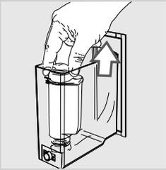
**24** Remova o pequeno filtro branco e torne a colocar o filtro de água "INTENZA+" (se presente) no reservatório de água.
