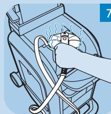
**7** Парогенератор можно поместить в термостойкий отсек сразу же после выключения.
