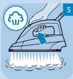
**5** При необходимости глажения с паром установите дисковый регулятор нагрева утюга в положение ●● или выше и нажмите кнопку включения пара **T**.
