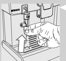
**7** 在操作完成时，将尾端装置重新安装到 Cappuccinatore（自动奶泡器）上。
