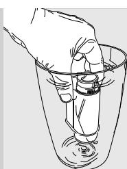
**3** 将“INTENZA+”滤水器垂直浸入冷水中（开口朝上），轻轻按压两侧，挤压出气泡。
