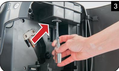
Curătați bine conducta de ieșire a cafelei cu coada unei lingurițe sau cu o altă ustensilă de bucătărie cu margini rotunjiți.
