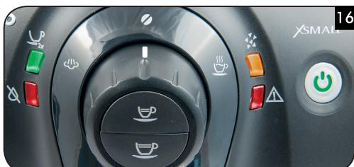
**RO** Toate ledurile luminează intermitent simultan
