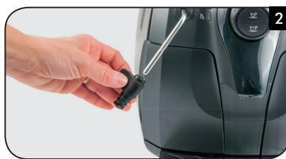
Desurubați partea superioară a dispozitivului Pannarello de pe duza de abur/apă caldă. Spălați-o cu apă proaspătă. Curățați duza de abur/apă caldă cu o cărpă umedă. Montați la loc partea exterioară a dispozitivului Pannarello.
