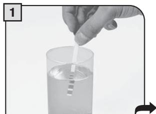
Mergulhe, por 1 segundo na água, o papel para o teste da dureza da água, presente na máquina.
