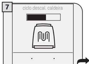
A máquina iniciará a distribuir a solução descalcificante através do tubo de distribuição de água quente. A distribuição acontecerá por intervalos preestabelecidos, para permitir agir à solução de forma eficaz.
