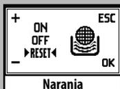
**i** Nota: cuando se sustituya un filtro “Intenza” por uno nuevo, se debe poner a cero la función. Sustituir el filtro como se ha descrito anteriormente.
