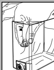
Retirar el filtro blanco instalado en el depósito, guardarlo en un lugar seco protegiéndolo del polvo.
