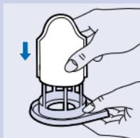
**2** Deslicen completamente la nueva bolsa en el armazón para la bolsa del polvo.
