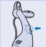
Prima di usare l'apparecchio per la prima volta, caricatelo per almeno 16 ore.
