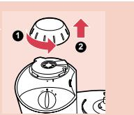
برای نصب کردن پارچ مخلوط کن بر روی موتور آنرا در جهت فلش بچرخانید تا محکم شود. دسته پارچ باید بطرف چپ باشد.
