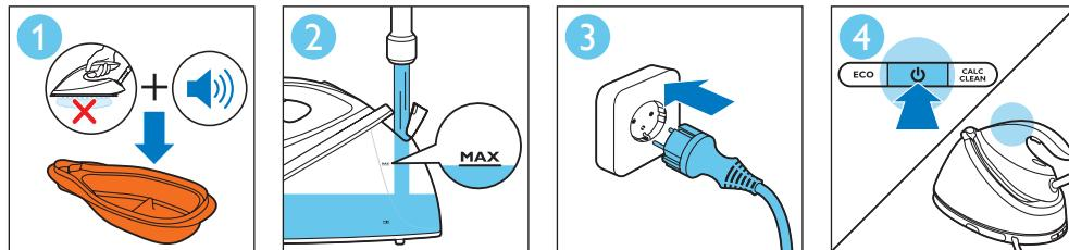
Fill water tank halfway / Wasserbehälter zur Hälfte füllen / Remplir le réservoir d'eau à moitié / Vul het waterreservoir tot halverwege
