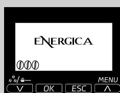
**14** Når alt vannet som trengs til skyllesyklusen er ført ut, avslutter maskinen automatisk avkalkningsprosessen og viser dette skjermbildet etter en kort oppvarmingsfase.
