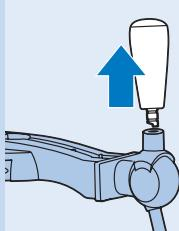
**5** Der Zapfhahn lässt sich aus dem Mittelstück der Zapfeinheit ziehen.
