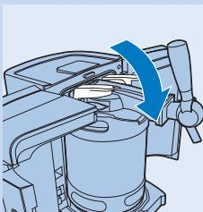
**4 Empuje hacia abajo las palancas azules de bloqueo hasta que estén en posición horizontal.**
