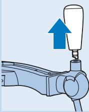
**5** Verwijder de hendel van de tapkraan door deze uit het tapkraanhuis te trekken.
