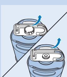
**1** Retirez le capot de protection et le tuyau du fût.
