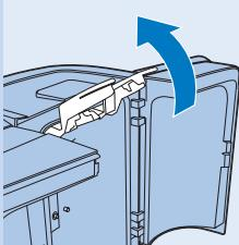
**2** Alzate completamente le due leve di bloccaggio blu.
