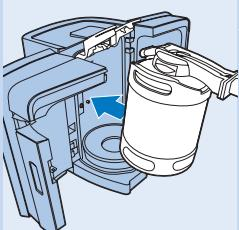
**3 Incline ligeramente hacia delante el barril con la unidad del grifo colocada y póngalo en el aparato.**
