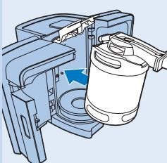
**3** Kippen Sie das Fass mit der darauf montierten Zapfeinheit leicht nach vorne und stellen Sie es in das Gerät.
