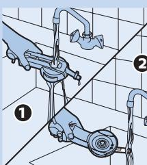
**2** Le cas échéant, retirez le connecteur tuyau et le tuyau du robinet. Placez le robinet sous l'eau, rincez le trou du connecteur tuyau (1) ainsi que l'élément de connexion à l'appareil (2). Si nécessaire, utilisez un peu de produit vaisselle.
