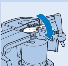
**4** Abbassate le leve di bloccaggio blu fino a che non si trovano in posizione orizzontale.
