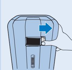
**1** Schieben Sie die Entriegelungstaste nach rechts, um die Klappen zu öffnen.
