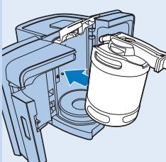
**3** Inclineate leggermente in avanti il barile con il rubinetto inserito e posizionate lo all'interno dell'apparecchio.
