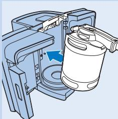
**3** Kantel het biervat, met de tapunit daarop bevestigd, een beetje naar voren en plaats het in het apparaat.
