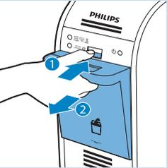
2 Pritisnite gumb za otpuštanje spremnika za vodu (1) i izvadite spremnik za vodu (2).
