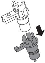
**19** Потягніть з'єднувач назовні та відокремте його від частини, що залишилася.
