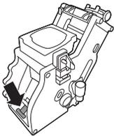
5 Перед повторним встановленням блоку заварювання перевірте, чи важіль контактує з основою блока.
