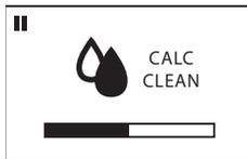
Чтобы поставить паузу при удалении накипи или при промывке, нажмите кнопку ESC. На экране появится следующий значок. Для продолжения цикла удаления накипи или цикла промывки нажмите кнопку OK.
