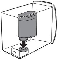
**16** Вийміть резервуар для води, спорожніть його, а потім вставте фільтр вертикально в роз'єм для фільтра.
