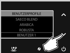
3 Die Taste "✓" für die Auswahl des freigegebenen Profils drücken, unter dem das Getränk programmiert werden soll.
