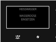
**6** Das nebenstehende Symbol wird angezeigt. Das Gerät zeigt an, dass die Wasserdüse installiert werden muss. Überprüfen, ob die Wasserdüse korrekt positioniert wurde. Zur Bestätigung "✓" drücken. Das Gerät beginnt, heißes Wasser auszugeben.
