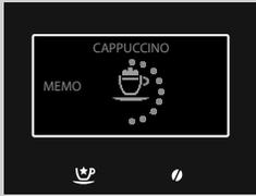
**6** Sobald das Gerät das seitlich abgebildete Symbol anzeigt, startet die Ausgabe der aufgeschäumten Milch in die Tasse. Nach Erreichen der gewünschten Menge aufgeschäumter Milch wird erneut die Taste des angewählten Getränks gedrückt. Die Ausgabe wird nach wenigen Sekunden beendet.
