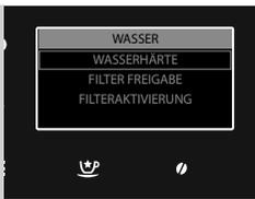
In **WASSERHÄRTE** kann der Härtegrad des Wassers eingestellt werden. Für die Messung der Wasserhärte ist auf das Kapitel "Messung und Programmierung Wasserhärte" Bezug zu nehmen.
