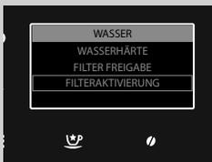
Mit **FILTERAKTIVIERUNG** erfolgt die Aktivierung des Filters nach dessen Installation oder Austausch. Hierzu ist auf das Kapitel "Installation Wasserfilter INTENZA+" Bezug zu nehmen.
