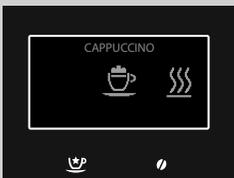
**8** Das Gerät benötigt eine Vorwärmzeit: In dieser Phase wird das seitlich abgebildete Symbol angezeigt.
