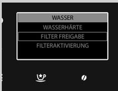
Mit **FILTER FREIGABE** weist das Gerät den Benutzer auf die Notwendigkeit des Austauschs des Wasserfilters hin.
