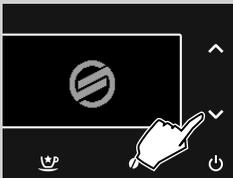
Nach der Freigabe können die Profile mit Druck der Taste "✓" oder der Taste "↗" angewählt werden. Diese sind dann sofort aktiv und das entsprechende Symbol wird angezeigt.
