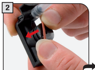
Den neuen O-Ring durch sanften Druck einsetzen.
