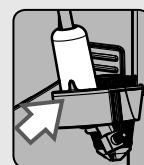
**RO** Introduceți furtunul de aspirare în dispozitivul automat de spumare a laptelui.
