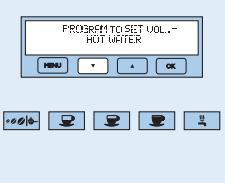
**3** Nyomja meg a forró víz gombját, míg a „PROGRAM TO SET VOL - HOT WATER” (MENNYISÉG PROGRAMOZÁSA - FORRÓ VÍZ) üzenet meg nem jelenik a kijelzőn.
