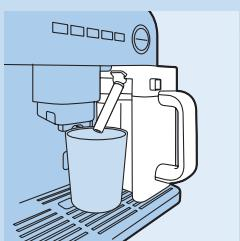
**6** Čvrsto pričvrstite posudu za mlijeko na mlaznicu. Stavite dovoljno veliku šalicu ispod žlijeba za kavu i pomaknite cijev za mlijecnu pjenu prema šalici.
