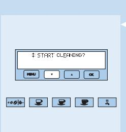
**2** Pritisajte gumb ▼, dokler se na zaslonu ne prikaže sporočilo "START CLEANING?" (ZAČETEK ČIŠČENJA?).
