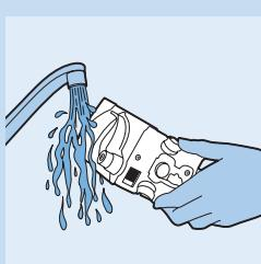
**5** Wyczyszć jednostkę zaparzającą pod ciepłą wodą z kranu. Nie używaj żadnych środków do czyszczenia.
