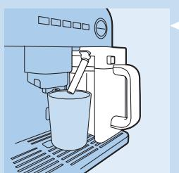
**6** Надежно установите кувшин для молока на насадку. Поставьте достаточно большую чашку под носик выхода кофе и поверните трубку взбивания пены к чашке.
