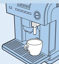
**3 Pritisnite gumb za vruću vodu dok se na zaslonu ne pojavi poruka "PROGRAM TO SET VOL - HOT WATER" (Program za postavljanje količine - vruća voda), a zatim ga otpustite.**
