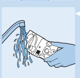
**5** Промойте варочный блок горячей водой из под крана. Не используйте чистящие средства для очистки блока.
