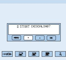
Ciągłe podgrzewanie wody na kawę prowadzi z czasem do osadzania się kamienia wewnętrz urządzienia. Gdy na wyświetlaczu zostanie wyświetlony napis „PLEASE DESCALING!” (Usuń kamień!), uruchom program usuwania kamienia. W tym celu wykonaj następujące czynności:
