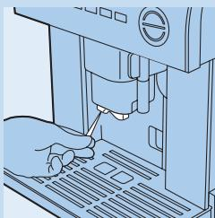
**4** Ujistěte se, že nejsou ucpané otvory ve výstupu kávy. Jestliže jsou ucpané, vyškrábejte uschlé zbytky kávy jehlou a odstraňte tak ucpaní.
