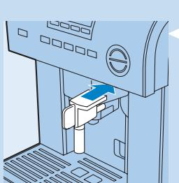
**6** Vložte výstup horké vody do přístroje.
