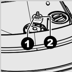
**2** Отметки, имеющиеся внутри емкости для кофе в зернах, указывают заданную степень помола. Можно выбрать 5 различных степеней помола, начиная с положения 1 для крупного помола и более легкого вкуса, и заканчивая положением 2 для мелкого помола и более насыщенного вкуса.
