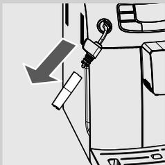
Всякий раз после вспенивания молока необходимо снять внешнюю часть классического вспенивателя молока и промыть ее свежей водой.
