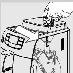
**2** С помощью кисточки (продается отдельно) или рукоятки столового прибора очистите отделение предварительно намолотого кофе.
