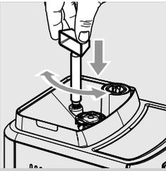
**1** Нажимайте и поворачивайте ручку для регулировки помола только на одно деление. Разница вкуса будет ощутимой после подачи 2-3 кофе.
