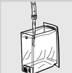
**12** Извлеките бак для воды, ополосните и наполните его свежей водой до указателя уровня MAX. Вставьте его обратно в машину.
