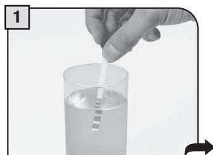
1 Sumergir en agua durante 1 segundo la tira de test que se suministra con la máquina para la prueba de la dureza del agua.
