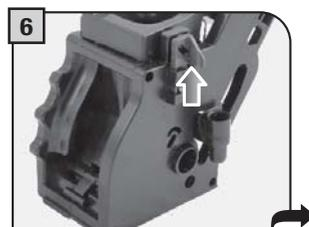
6 Asegurarse de que los componentes estén en la posición correcta. El gancho que se muestra tiene que estar en la posición correcta; para comprobarlo presionar el botón "PUSH".
