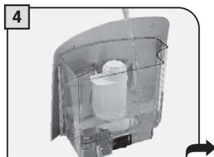
4 Llenar el depósito con agua potable fresca y volver a introducirlo en la máquina.
