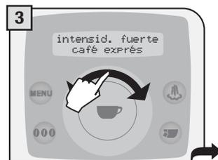
**3** Deslizar un dedo sobre el disco táctil para seleccionar la bebida deseada.
