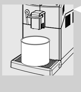
**8** Neku posudu dovoljnog kapaciteta (1,5 l) postavite ispod cevi za paru/toplu vodu i ispod bloka za ispuštanje kafe.
