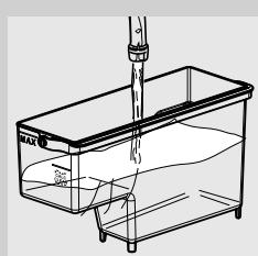
**6** Uspite sav rastvor za uklanjanje naslaga kamenca u rezervoar za vodu. Zatim rezervoar napunite svežom vodom sve do nivoa CALC CLEAN.
