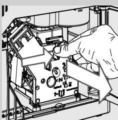
**4** Da biste izvukli blok za pripremu kafe, pritisnite taster «PUSH» potežući ručku. Izvucite ga u horizontalnom položaju bez okretanja.
