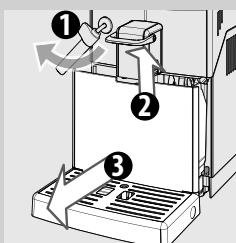
**17** Da biste očistili posudu za kapanje, u unutrašnjost posude stavite tabletu za odmašćivanje i napunite je sve do 2/3 topлом vodom. Ostavite da rastvor za čišćenje deluje oko 30 minuta, zatim isperite sa obilnom količinom vode.
