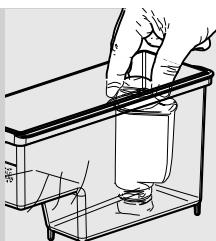
**20** Uklonite mali beli filter i vratite na mesto filter za vodu "INTENZA+" (ako je prisutan) u rezervoar za vodu; napunite ga svežom vodom do nivoa MAX. Vratite ga u aparat.
