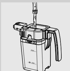
**4** Enlever la partie supérieure et remplir la carafe à lait avec de l'eau fraîche jusqu'au niveau MAX.
