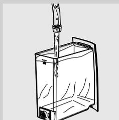
**14** Extraire le réservoir à eau, le rincer et le remplir avec de l'eau fraîche jusqu'au niveau MAX. Le réinsérer dans la machine.
