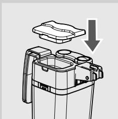
**5** Replacer la partie supérieure sur la carafe à lait.
