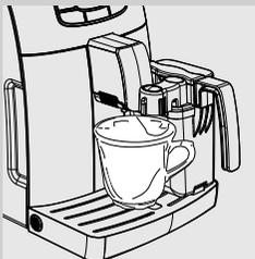
**8** Placer un récipient suffisamment grand (1,5 l) sous la buse de distribution de la carafe à lait et sous la buse de distribution du café.
