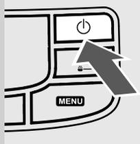
**13** Pour mettre la machine en marche, appuyer sur la touche «
