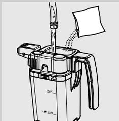
**1** Remplir la carafe à lait avec de l'eau jusqu'au niveau (MAX).
