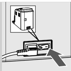
**12** Mettre l'interrupteur général sur « I » pour mettre la machine en marche. L'icône de Stand-By apparaît sur l'afficheur.
