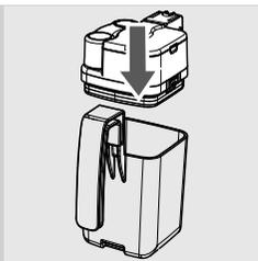
**3** Monter le couvercle sur la carafe à lait en s'assurant qu'il est bien fixé.
