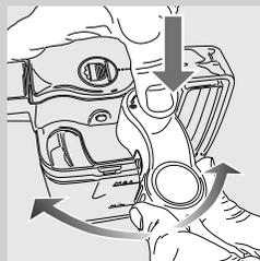
**2** Appuyer avec force sur le joint de rotation en le tournant au moins deux ou trois fois à un angle de 45° comme le montre la figure.
