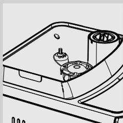
Nettoyer le réservoir à café en grains une fois par mois quand il est vide avec un chiffon humide afin d'éliminer les substances huileuses du café. Le remplir à nouveau avec le café en grains.
