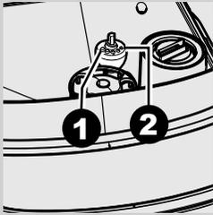
**2** Les repères à l'intérieur du réservoir à café en grains indiquent le degré de mouture réglé. 5 degrés de mouture différents peuvent être réglés, de :
