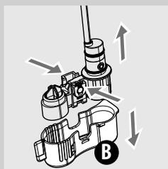
**16** Séparer le couvercle (B) de la buse de distribution de la carafe à lait en poussant vers le bas et en exerçant une légère pression sur les côtés.
