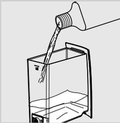
**6** Extraire le réservoir à eau et y verser tout le contenu du détartrant Saeco. Remplir le réservoir avec de l'eau fraîche jusqu'au niveau MAX.
