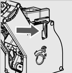
**10** S'assurer que le crochet pour le blocage du groupe de distribution est dans la bonne position ; pour ce faire, appuyer fermement sur la touche « PUSH » jusqu'à l'enclenchement. Veiller à ce que le crochet soit en haut à la butée. Dans le cas contraire, essayer à nouveau.
