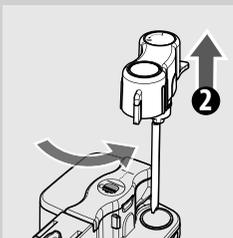
**13** Soulever la buse de distribution pour l'extraire du couvercle de la carafe. La buse de distribution de la carafe à lait est composée de six pièces qu'il faut démonter. Chaque pièce est identifiée par les lettres majuscules (A-E) indiquées ci-après dans les images correspondantes aux différentes phases.
