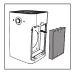
5 将预过滤网正确放回产品后,重置空气净化过滤网使用寿命计数器。 (请参阅第7章"重置滤网使用寿命计数器"。)
