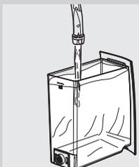
12 Extraire le réservoir à eau, le rincer et le remplir avec de l'eau fraîche jusqu'au niveau MAX. Le réinsérer dans la machine.
