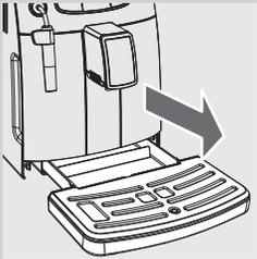
**15** Pour nettoyer le bac d'égouttement, mettre une tablette de dégraissage dans le bac et le remplir avec 2/3 d'eau chaude. Laisser agir la solution de nettoyage pendant 30 minutes environ puis rincer abondamment.
