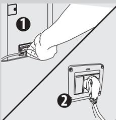
**10** Brancher la fiche sur la prise de courant placée au dos de l'appareil.
