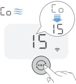
**Modo de ventilación:** en el modo de ventilación, el producto puede funcionar como ventilador en los días calurosos. La calefacción se apagará y el ventilador expulsará una corriente de aire ideal para que las habitaciones cálidas resulten más cómodas.
