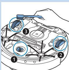
*Примечание. Важно регулярно проводить очистку датчиков перепада высот. Если датчики перепада высот будут загрязнены, робот-пылесос не сможет распознать перепад высот.*
