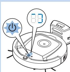
**3** Індикатор батареї на дисплей док-станції та індикація на кнопці “увімк./вимк.” на роботі почнуть блимати.
