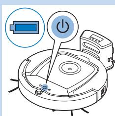
**4** Зарядталмалы батарея толығымен зарядталғанда, қондырма станса дисплейіндегі батарея индикаторы және роботтағы қосу/өшіру түймесіндегі шам жыптылықтауын тоқтатады.
