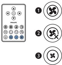
За допомогою кнопок швидкості вентилятора можна збільшувати швидкість обертання вентилятора до турбошвидкості або взагалі вимикати вентилятор. Налаштування за замовчуванням – нормальна швидкість обертання вентилятора.
