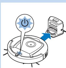
**Примечание.** Робот-пылесос автоматически возвращается на док-станцию, только если цикл уборки начинался от док-станции.
