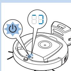
**3** Қондырма станса дисплейіндегі батарея индикаторы және роботтағы қосу/өшіру түймесіндегі шам жыптылықтай бастайды.
