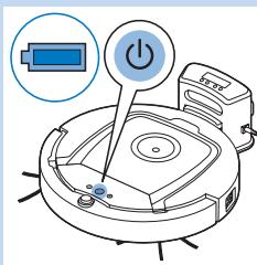
**4** Коли акумуляторна батарея повністю зарядиться, індикатор батареї на дисплей док-станції та індикація на кнопці “увімк./вимк.” на роботі перестануть блимати.
