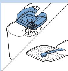
**4** Витрусьте вміст контейнера для пилу над смітником, щоб спорожнити його. Почистіть фільтр і внутрішню частину контейнера для пилу ганчіркою або зубною щіткою із м'яким ворсом. Почистіть також отвір всмоктування на дні контейнера для пилу.
