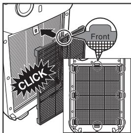
7 要装回前面板，请先将顶部的挂钩插到净化器顶部(1)。然后，朝净化器机身方向推动面板(2)。
