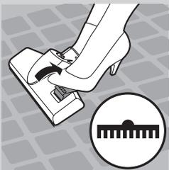
Du kan använda kombinationsmunstycket på mattor (med borsten infällda) eller på hårda golv (med borsten utfällda).
