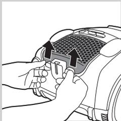
**1** Avaa HEPA-poistosuodattimen ritilä vetämällä sitä sen kielekkeistä ylöspäin, jotta se irtoaa laitteesta.
