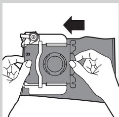
**6** Vuelva a colocar el soporte de la bolsa en el aspirador.
