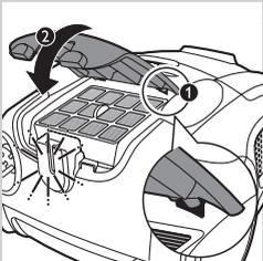
**6** Gitteret foran HEPA-udstødningsfilteret lukkes ved først at sørge for, at tapperne øverst på gitteret er ud for hullerne i apparatet (1). Tryk derefter tapperne nedad, indtil gitteret låser på plads (2) ("klik").
