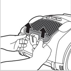
**1** Du åpner HEPA-utløpsfiltergitteret ved å ta tak i tappene og trekke gitteret oppover for å fjerne det fra apparatet.
