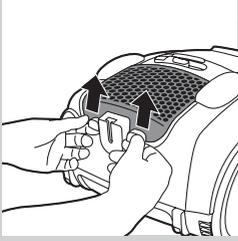
**1** Pour ouvrir la grille du filtre sortie HEPA, tirez la grille vers le haut à l'aide des languettes pour la retirer de l'appareil.
