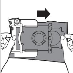
**4** Træk i pappladen for at få den fyldte støvpose ud af kassetten.
