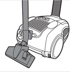
*Nota: Se desiderate fare una pausa, inserite la scanalatura della bocchetta nell'alloggiamento di sospensione per riporre il tubo nel modo più conveniente.*
