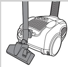
*Nota: Si quiere hacer una pausa, inserte el saliente del cepillo en la ranura para aparcar con el fin de fijar el tubo en una posición cómoda.*
