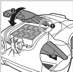
**6** Sulje HEPA-poistosuodattimen ritilä kohdistamalla sen yläosassa olevat kielekkeet laitteen vastaaviin koloihin (1). Paina kielekkeitä alas, kunnes ritilä lukittuu paikalleen (2) (napsahtamalla).
