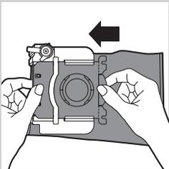
**5** Skyd pappladen på den nye støvpose så langt ned i sliderne på støvposekassetten, den kan komme.
