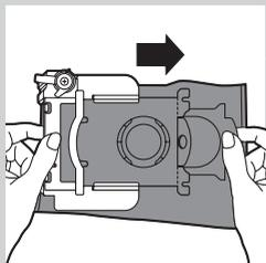
**5** Deslice la parte delantera de cartón de la nueva bolsa por las dos ranuras del soporte de la bolsa hasta el fondo.
