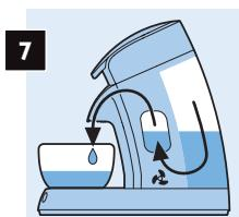
L'eau du réservoir circule dans la cafetière et la chaudière se remplit d'eau. Cette opération s'arrête automatiquement, ne l'interrompez pas !
