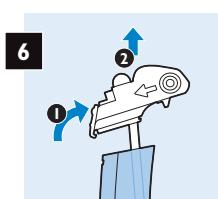
Retirez le couvercle du réservoir de lait.
