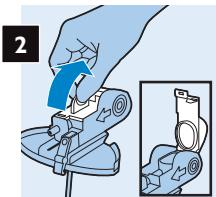
Ouvrez le capot bleu du réservoir de lait.
