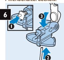
Setzen Sie den Dampfeinlass wieder ein, stecken Sie den Milchschauch fest auf den Anschluss des Milchbehälterdeckels, und schließen Sie die Abdeckung des Milchbehälterdeckels.
