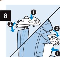
Bevestig het deksel weer, plaats de melkreservoirunit in de machine en druk de hendel omlaag.
