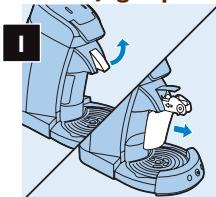
Levez le levier et retirez l'unité du réservoir de lait de l'appareil.
