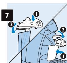
Befestigen Sie den Deckel, setzen Sie die Milchbehälter-Einheit wieder in die Maschine ein, und drücken Sie den Hebel nach unten.
