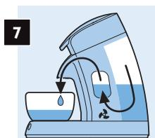
Het water in het waterreservoir wordt door de machine gespoeld en de boiler wordt met water gevuld. Dit proces stopt automatisch, onderbreek het niet!
