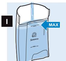
Füllen Sie den Wasserbehälter mit Wasser.
