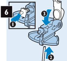
Renforcez l'arrivée de vapeur, fixez fermement le bec d'admission de lait sur le raccord du couvercle du réservoir de lait, puis fermez le capot.
