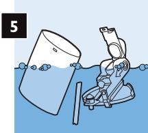
Nettoyez le réservoir de lait, son couvercle et le bec d'admission de lait au lave-vaisselle (récommandé) ou à l'eau chaude additionnée d'un peu de produit vaisselle. Rincez les éléments à l'eau froide une fois nettoyés.
