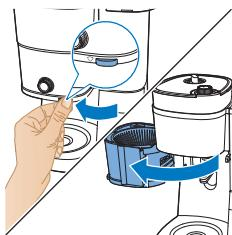
**2 打开滤网固定架，即可接触到咖啡粉漏斗斜槽。**
