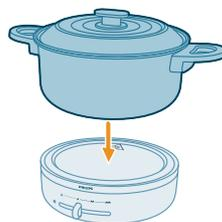
3 将煮锅放置于加热底座上，确保煮锅和加热底座之间没有异物和水分，煮锅没有倾斜。
