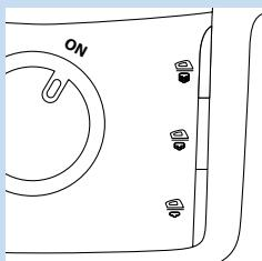
**注意：**出于安全考虑，如果超过 10 分钟不使用熨斗，产品将自动关闭。自动关熄指示灯将闪烁。按任何按钮均可再次打开产品电源。
