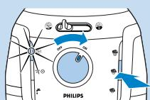
注意：唯有產品處於充分冷卻狀態時才能啟動手動除鈣程序。如果手動除鈣過程產品過熱，蒸汽選項按鈕指示燈會閃爍並且持續加熱備用。
