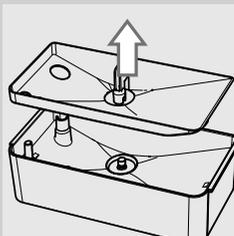
**5** Die Schale entfernen. Die Schale und den Behälter mit einem Tuch reinigen.
