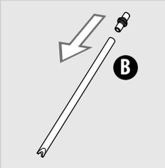
**13** Das Anschlussstück (B) in den Ansaugschlauch stecken.
