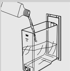
**8** Das gesamte Entkalkungsmittel in den Wassertank einfüllen. Dann den Wassertank bis zum Füllstand CALC CLEAN mit frischem Wasser füllen.
