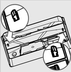
**4** Für die Herausnahme der Schale wird auf die Haken am Boden des Kaffeebohnenbehälters gedrückt, wie in der Abbildung gezeigt.
