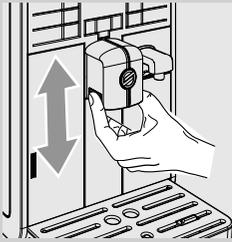
Der Kaffeeauslauf kann in der Höhe eingestellt werden, um ihn an die Abmessungen der verwendeten Tassen anzupassen.
