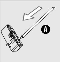
**14** Den Ansaugschlauch mit dem Anschlussstück (A) in den Milchaufschäumer einstecken.
