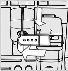
3 Die Karaffe in das Gerät einsetzen. Den Auslauf der Karaffe nach links bis zum Symbol "☕" herausziehen.
