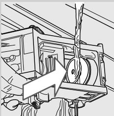
**5** Die Brühgruppe mit frischem und lauwarmem Wasser reinigen. Den oberen Filter sorgfältig reinigen.
