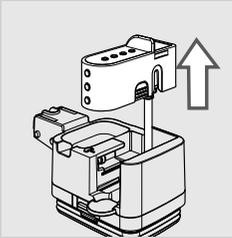
**3** Den Deckel anheben, um ihn vom oberen Teil der Karaffe abzunehmen. Der Auslauf der Karaffe besteht aus sechs Teilen, die auseinander gebaut werden müssen. Jedes Teil wird mit einem Großbuchstaben (A, B, C, D, E, F) gekennzeichnet, wie in den Abbildungen unten gezeigt.
