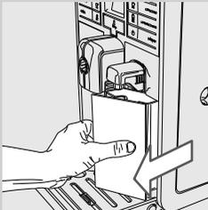
**1** Den Kaffeesatzbehälter täglich bei eingeschaltetem Gerät entleeren und reinigen.
