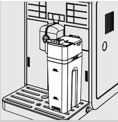
**2** Die Milchkaraffe bis zum Füllstand MIN mit Wasser füllen und wieder in das Gerät einsetzen.
