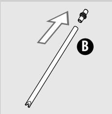
**5** Das Anschlussstück (B) vom Ansaugschlauch abnehmen.
