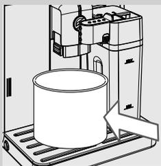
**14** Die Milchkaraffe in das Gerät einsetzen. Den Auslauf der Karaffe nach links bis zum Symbol "▲" herausziehen. Einen Behälter unter den Auslauf der Karaffe stellen, um den Spülzyklus zu starten.
