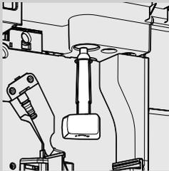
**7** Den unteren Bereich der Kaffeezufuhr mit den im Lieferumfang des Geräts enthaltenen und dafür bestimmten Utensilien oder mit dem Stiel eines Teelöffels reinigen. Es ist sicherzustellen, dass die für die Reinigung bestimmten Utensilien wie in der Abbildung dargestellt eingesetzt werden.
