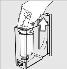
**24** Den kleinen weißen Filter entfernen, den Wasserfilter "INTENZA+" (soweit vorhanden) wieder im Wassertank installieren.
