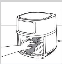
**6** 用热水和非磨蚀性海绵清洗产品内部。
