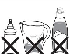
**Внимание! Во избежание протекания подошвы, появления коричневых пятен или повреждения устройства не используйте парфюмированную воду, воду из сушильной машины, уксус, крахмал, средства очистки от накипи, добавки для гладжения, химические вещества и воду, подвергшуюся очистке с использованием химических средств.**
