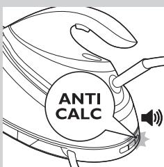
Картридж очистки от накипи необходимо заменять при появлении мигающего индикатора замены и звукового предупреждения на приборе.
