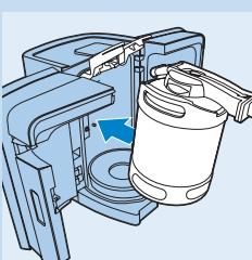
**3** Kantel het biervat, met de tapunit daarop bevestigd, een beetje naar voren en plaats het in het apparaat.
