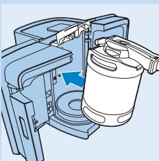
**3** Inclinez légèrement le fût avec son robinet vers l'avant et poussez-le à l'intérieur de l'appareil.
