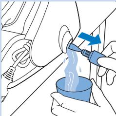
**6** Entfernen Sie den EASY DE-CALC-Verschluss, und lassen Sie das Wasser mit Kalkpartikeln in die Tasse fließen.
