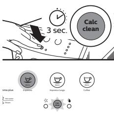
**7** Lampen för avkalkningscykeln lyser med fast sken. Bryggaren pumpar ut avkalkningslösningen i omgångar under cirka tjugo minuter.
