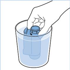
**2** 從包裝中取出濾網，將其浸泡在冷水中，並將開口朝上。輕按濾網兩側，將氣泡洩出。
